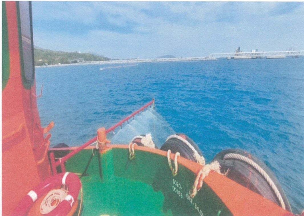
STT 15 เรือ ACS 9 และ ACS 5 กางแขนฉีดน้ำยา Dispersant กำจัดเก็บคราบน้ำมันบนผิวน้ำที่อยู่นอก Boor
