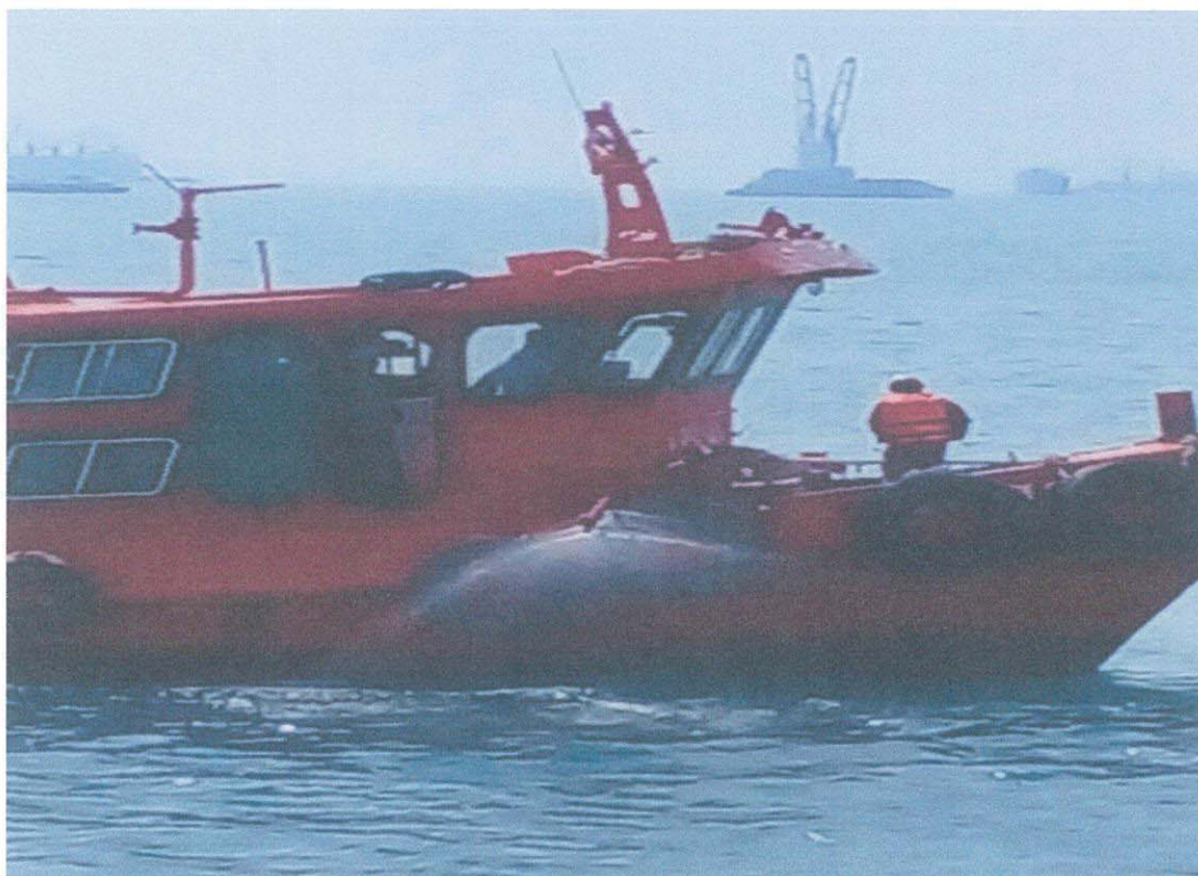
STT 16 เรือ ACS 9 และ ACS 5 กางแขนฉีดน้ำยา Dispersant กำจัดเก็บคราบน้ำมันบนผิวน้ำที่อยู่นอก Boor
