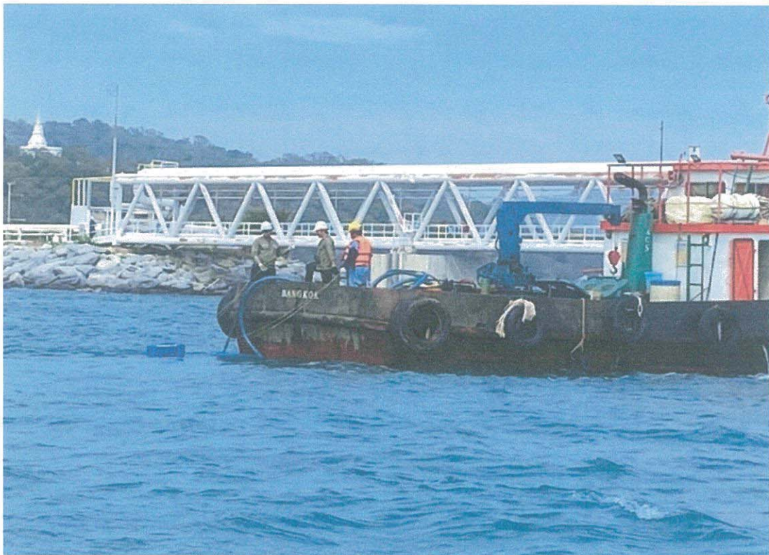
STT 13 เรือ ACS 2 นำ Disskimmer ลงเก็บคราบน้ำมันที่หักเก็บอยู่ใน Boom
