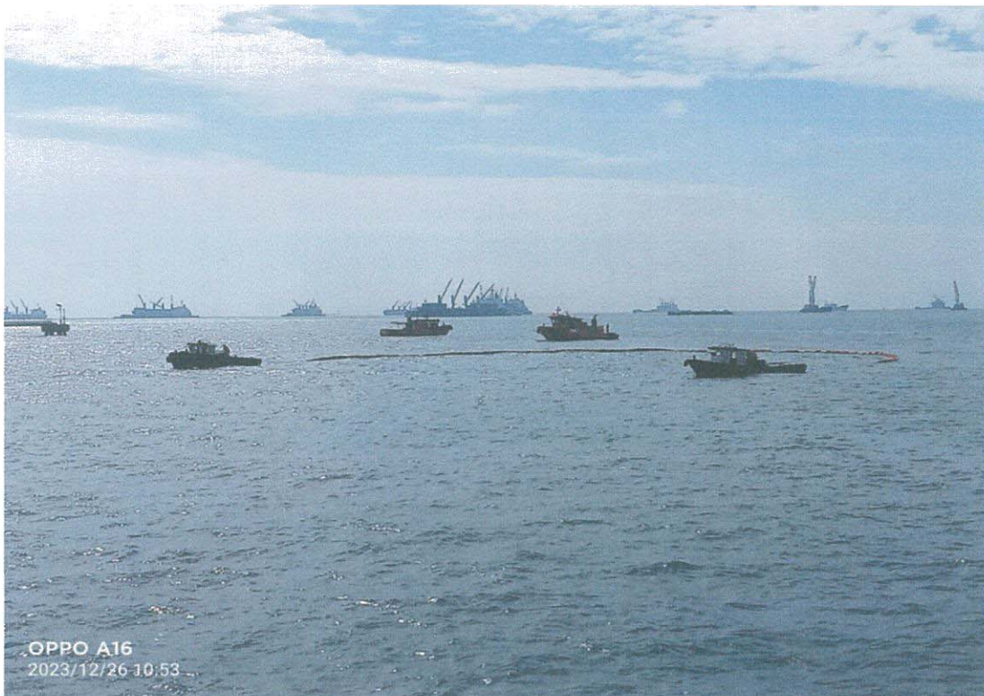
STT 10 เรือรับเชือกถล่ม Boom เพื่อกักเก็บน้ำมันที่หกรั่วไหลลงทะเลและปิดกั้นน้ำมันไม่ให้ น้ำมันกระจาย
