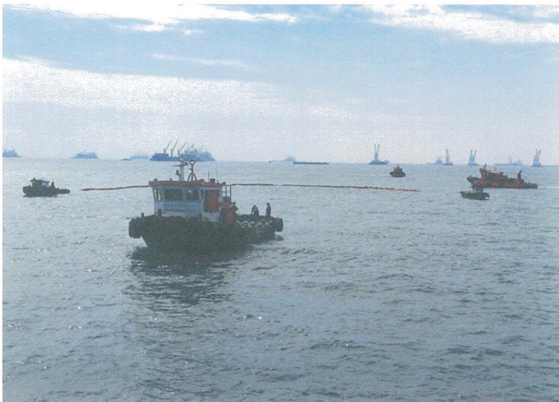
STT 12 เรือ ACS 2 นำ Disskimmer และอุปกรณ์ในการสูบน้ำมัน เตรียมสูบน้ำมันใน Boom
